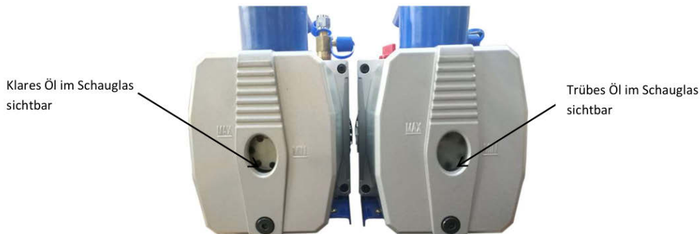
Foto: Effektivität der Vakuum-Kühlfalle - Sauberkeit des Öls in den Vakuumpumpen (links: klares Öl bei Verwendung einer Vakuum-Kühlfalle, rechts: trübes Öl, wenn keine Vakuum Kühlfalle verwendet wurde)
