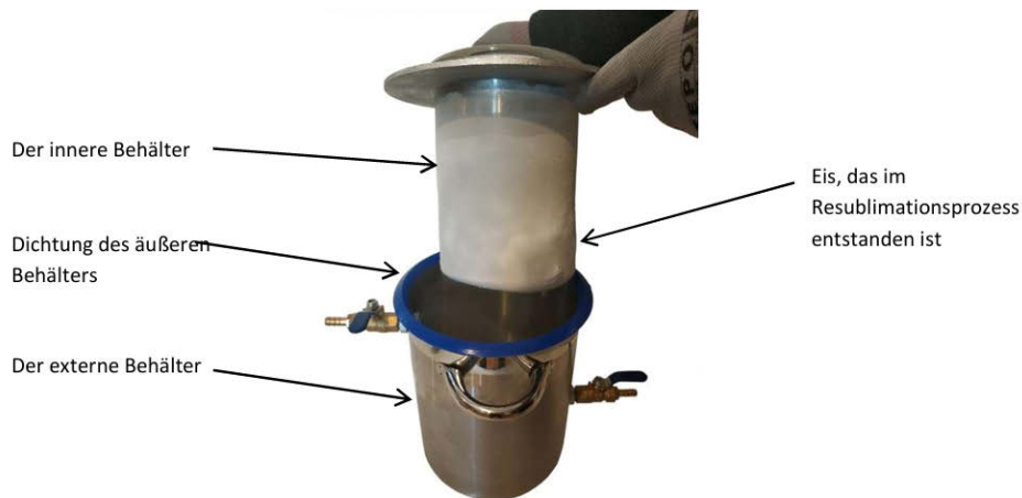
Foto: Interner und externer Behälter und das erfrorene Material, das auf dem inneren Behälter gesammelt wurde.
