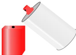
Zu verklebende Oberfläche mit ACTIVATOR SPRAY besprühen und 30 Sekunden ablüften lassen.
