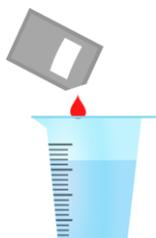
Den Beutel mit EFFECT Colour Paste aufschneiden und den Inhalt **komplett** zu der Harz-Härter-Mischung geben.
