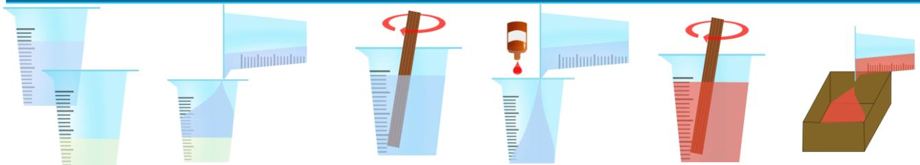
Bei Teilmischungen: Harz und Härter genau in separate Behälter einwiegen.
